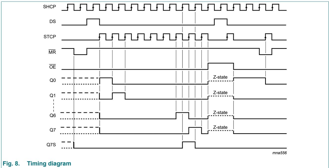
**Fig. 8. Timing diagram**
