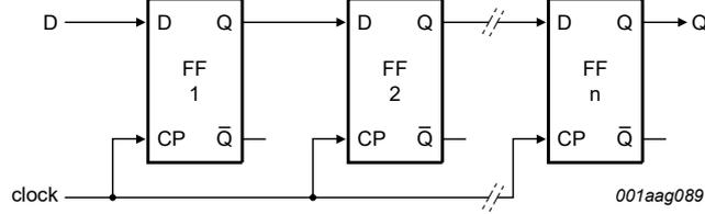
Fig. 7. N-stage shift register
