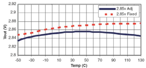
Fig. 12:  $V_{IN}=4.85V$ ,  $I_{OUT}=10mA$
