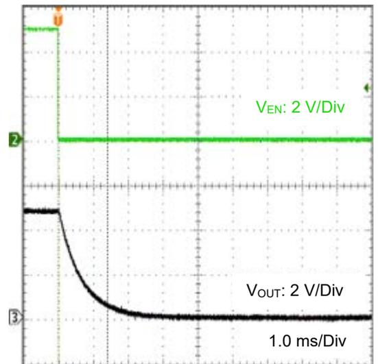
Figure 28. EN Shutdown Waveform
