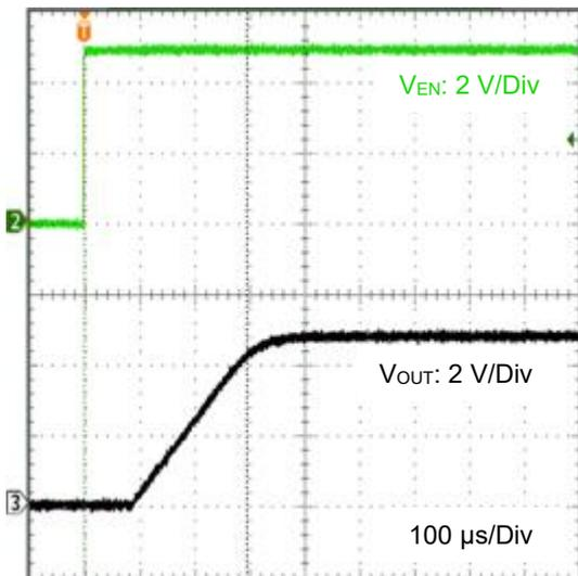
Figure 27. EN Startup Waveform
